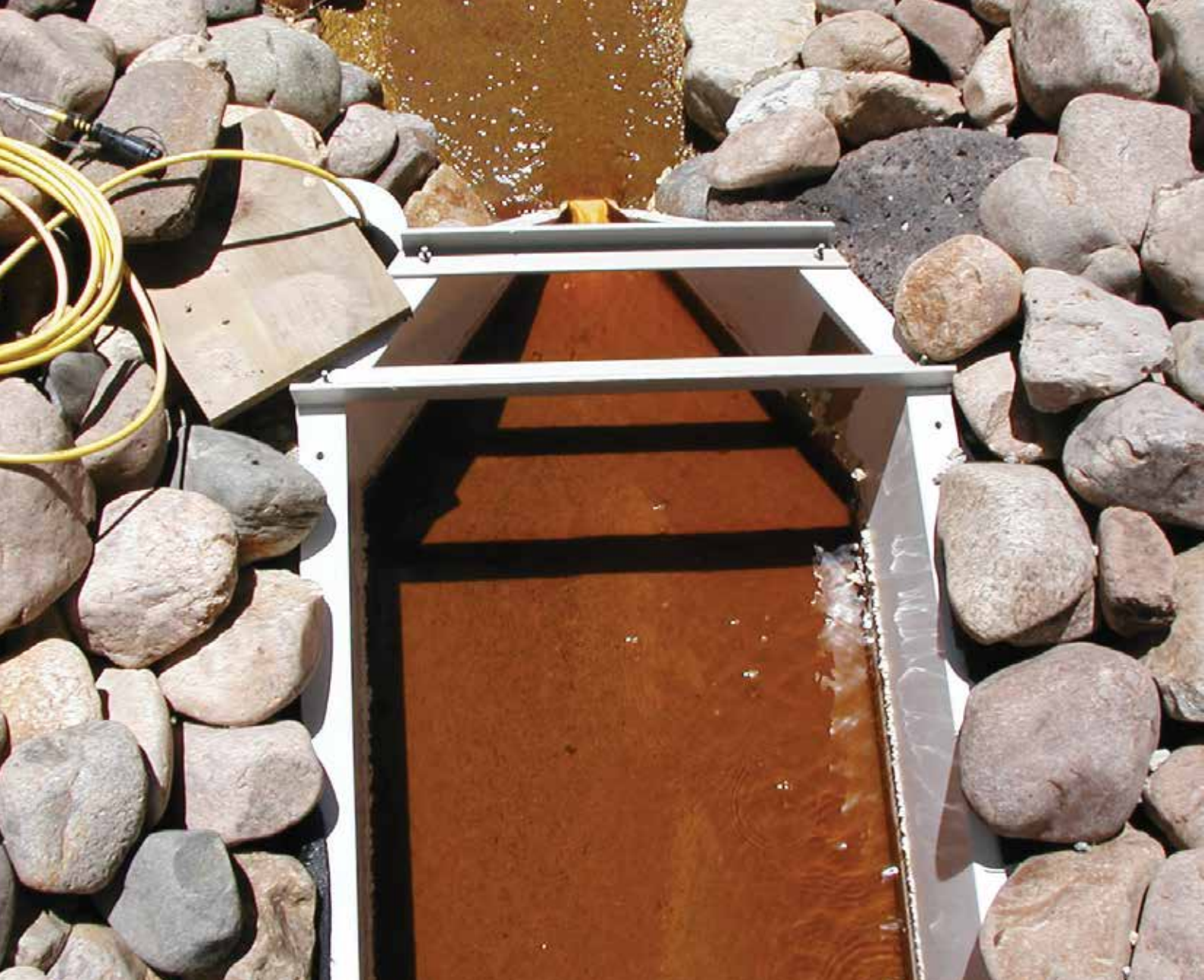
Medición continua del caudal de filtraciones proveniente de una pila de roca, Mina Questa, Nuevo México
